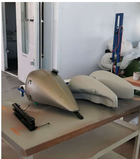
Légende de la photo : Les peintures spéciales pour réservoir de moto sont également très demandées chez les professionnels de la peinture. Ceux-ci sont d'abord apprêtés.
