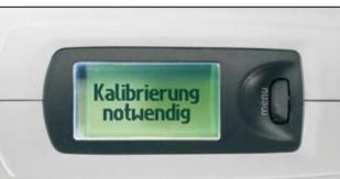
Das Genius-Gerät sollte mit Hilfe der Standards wöchentlich kalibriert werden. Die Standards müssen dazu unbedingt sauber gehalten werden. Benutzen Sie zur Reinigung warmes Wasser und ein weiches Tuch. Bei starker Temperaturänderung sollte erneut kalibriert werden.
