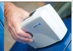
Jede Farbtonmessung benötigt drei Messungen in unterschiedlichen Richtungen auf demselben Messpunkt. Die Messung muss möglichst nahe an der Schadstelle erfolgen. Bei fehlerhafter Messung wird dies auf dem Display des Gerätes angezeigt. Der zu messende Bereich muss unbedingt plan sein. Eine Messung an Kanten oder gewölbten Oberflächen kann das Messergebnis verfälschen.
