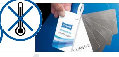
Mit Hilfe des Standoblue Effect Navigator kann die Grobheit des Effektgebers direkt am Fahrzeug bestimmt werden. Die Helligkeitsstufe wird bei der Messung automatisch von Genius bestimmt.
