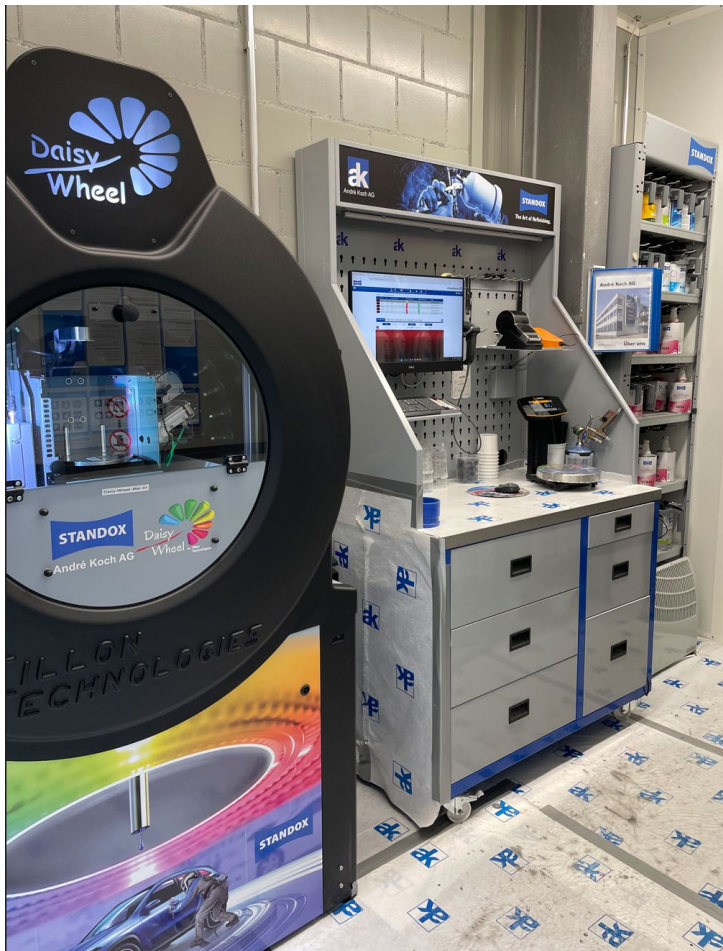
Bildunterschrift: In die Zukunft investiert: Im Farbmischraum der Autobahn-Garage Zwahlen & Wieser AG steht auch die Daisy Wheel 3.0, ein modernes, vollautomatisches Lackmischsystem.
