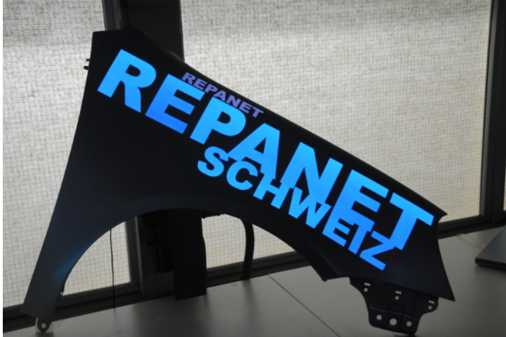
Bildunterschrift 4: Ein echter Hingucker: Durch Anlegen einer elektrischen Spannung wird eine Lackschicht dazu angeregt, elektromagnetische Strahlung in Form von Licht abzugeben.
