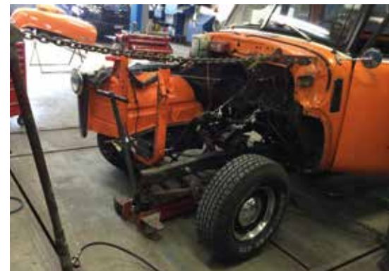
Der verzogene Rahmen brauchte eine Behandlung auf der Richtbank.
