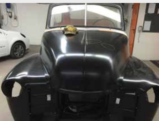
Die Neuteile aus den USA machten an der Front wegen mangelhafter Passgenauigkeit viel Arbeit.
